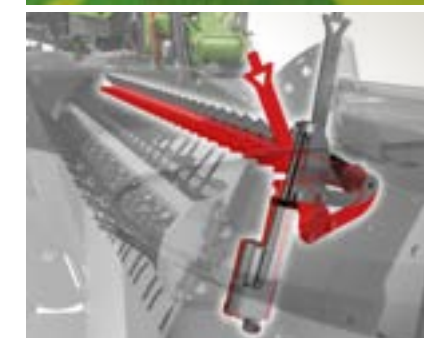
De elektromotor regelt de tegenkam van de kneuzer, die verantwoordelijk is voor de intensiteit van de kneuzing, traploos
