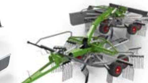
Zijafleg getrokken treintjesmodel Uiterst wendbaar en flexibel met 1- of 2-zwadafleg Werkbreedtes van 6,30 – 7,00 m
