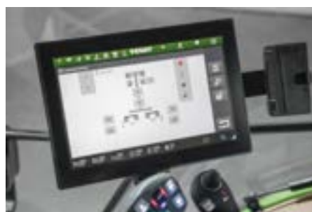
ISOBUS UT: bedieningsschermen kunnen op de trekkerterminal worden overgedragen ISOBUS AUX-N: overdracht op de rijhendel mogelijk
