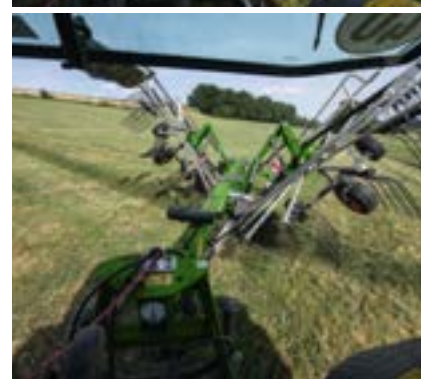
De standaard volgordesturing levert perfecte zwaden op de kopakker en aan de randen en geren van het veld
