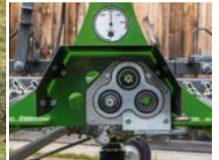
Universele transmissie van gegoten lichtmetaal, voor front- en achteraandrijving.
