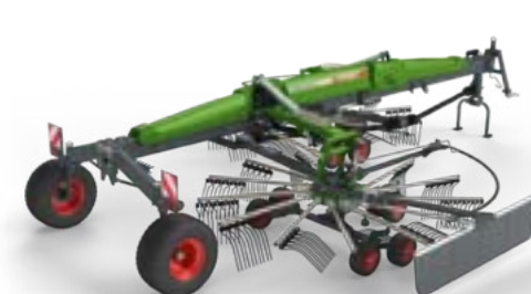
Zijafleg met transportonderstel Zeer veelzijdig en hoge werksnelheid met 1- of 2-zwadafleg Werkbreedtes van 5,75 – 8,40 m
