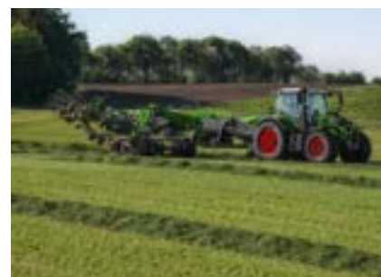
De innovatieve volgsturing gebeurt elektronisch via het tijds- of wegsignaal en kan individueel worden aangepast – dankzij het nieuwe ISOBUS-systeem.
