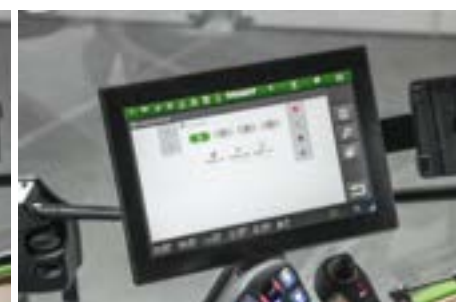
ISOBUS UT: bedieningsschermen kunnen op de trekkerterminal worden overgedragen ISOBUS AUX-N: overdracht op de rijhendel mogelijk
