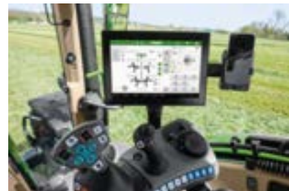
ISOBUS UT: bedieningsschermen kunnen op de tractorterminal worden overgedragen ISOBUS AUX-N: Rijhendeloverdracht is mogelijk
