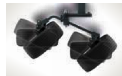
De als extra leverbare stuurbare tandemas van de Former 7850 maakt het mogelijk om ook in bochten de bodem optimaal te blijven volgen, en daarbij minder te schrapen en voor meer bescherming van de graszode.
